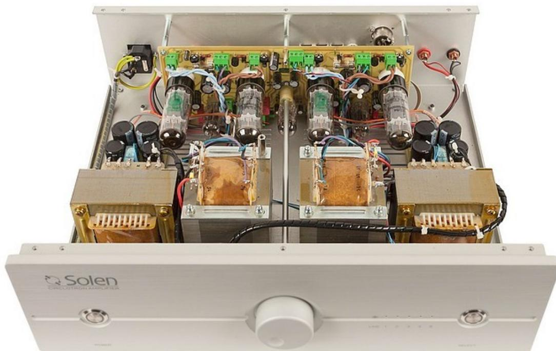
L'un des gros avantages du montage Circlotron avec les tubes est qu'il diminue les contraintes sur le transformateur de sortie. Les transformateurs sont pilotés en charge cathodique donc en basse impédance.
